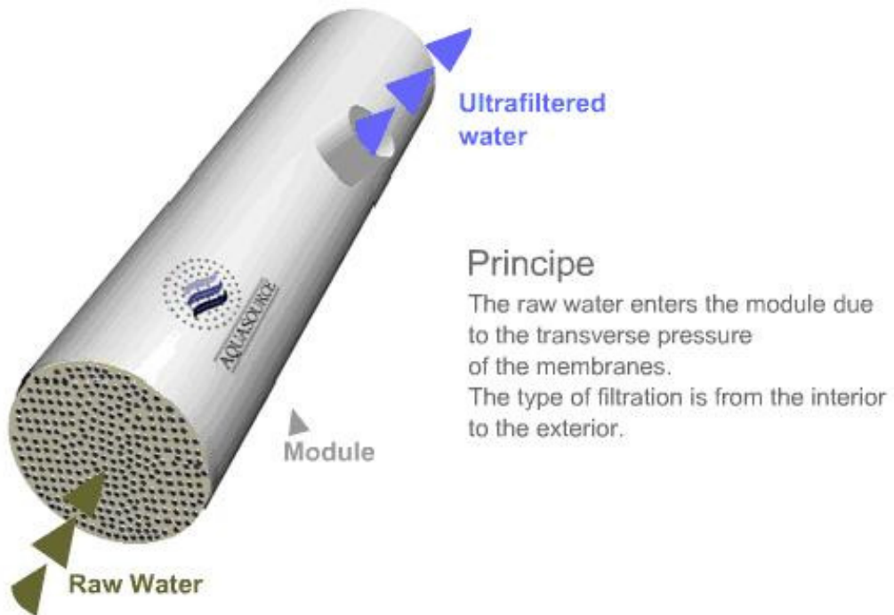
شكل (٤٣) غشاء الترشيح والتعقيم في جهاز أكواسورس للترشيح الفائق
