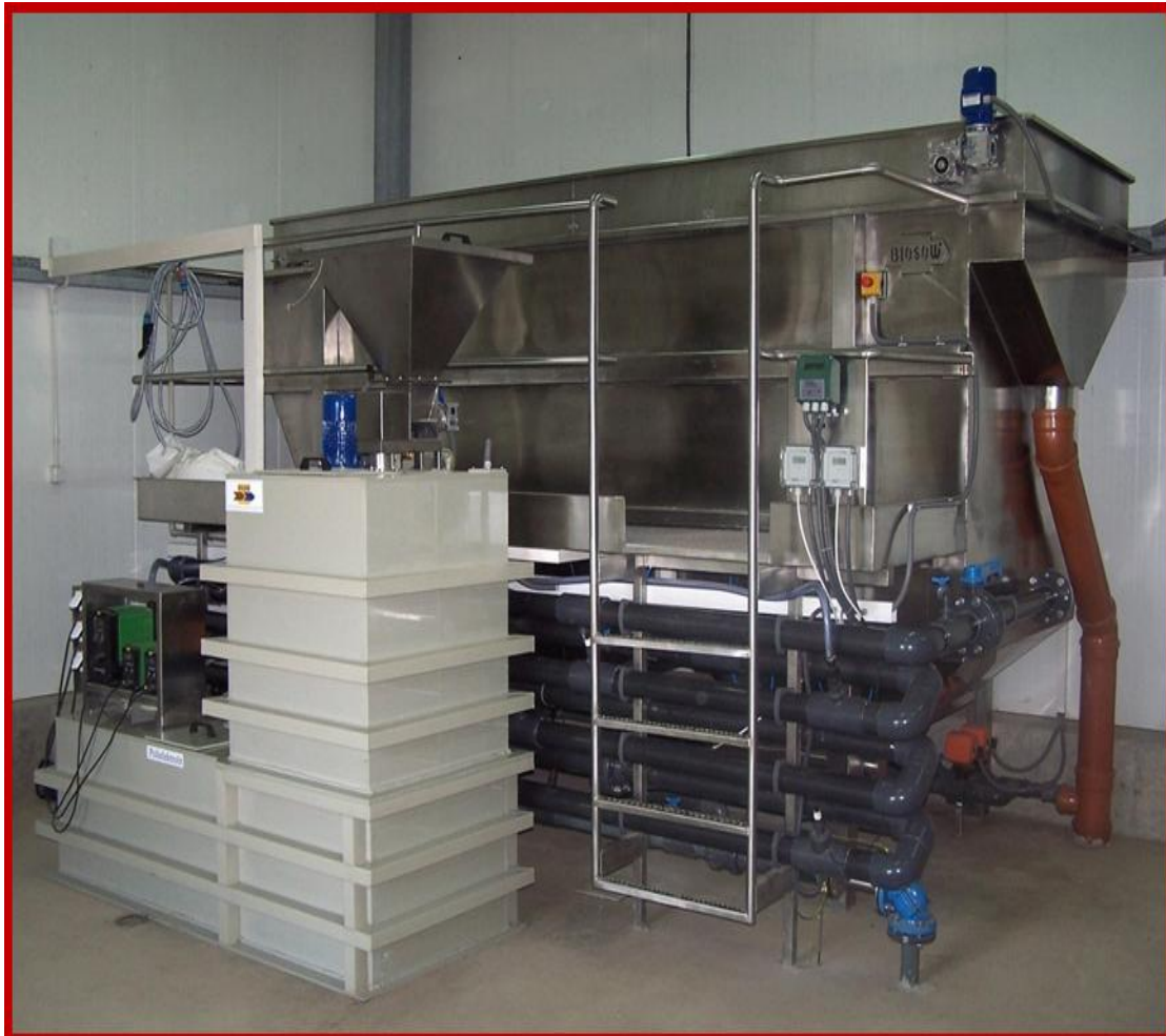
شكل ( ٢ ) وحدة الطفو الهوائي المذاب
