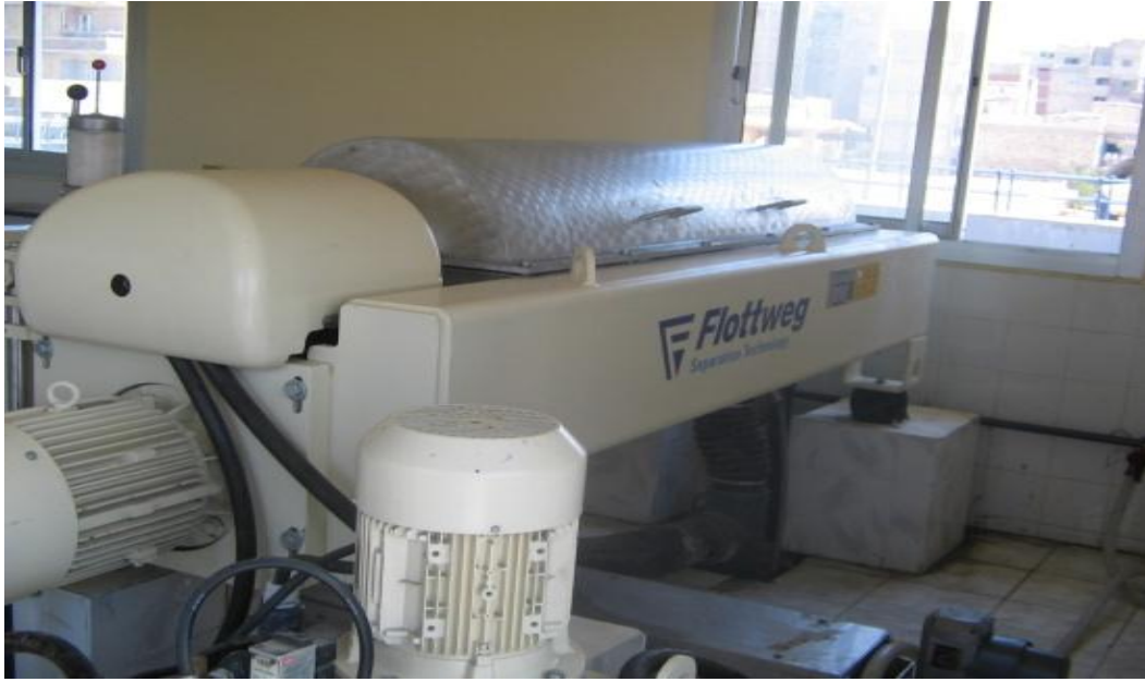
صورة رقم 17 لمعدة التجفيف باستخدام الطرد المركزي
