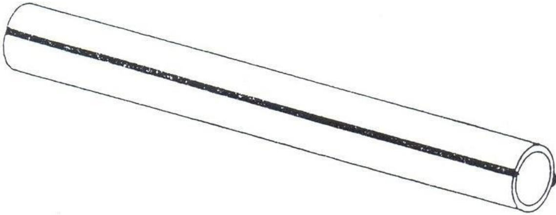
شكل رقم ( 6 ) خط منتج ذو لزوجة عالية وبجانبه خطي بخار تسخين (STEAM TRACER)
