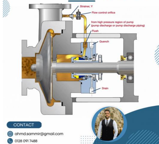
البوست الثالث عشر: مخططات التبريد API Plan 01-11-12
