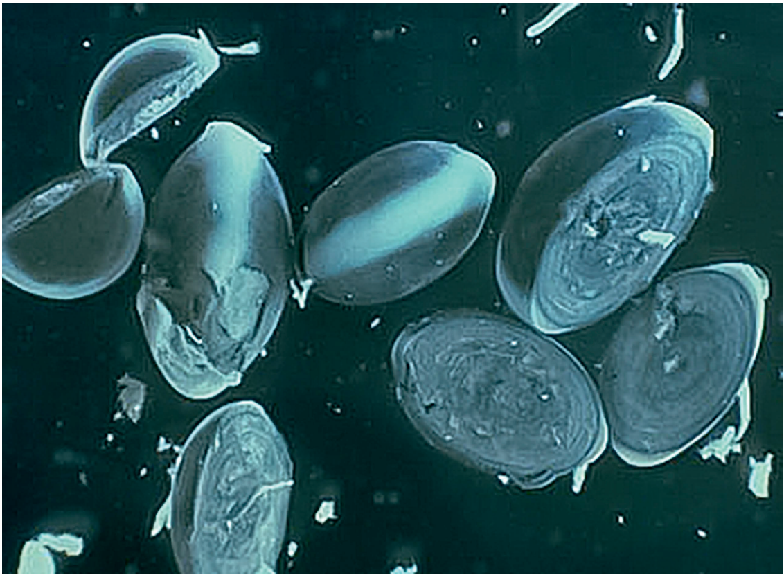
Anaerobic sludge (photo: J.B. van Lier).
