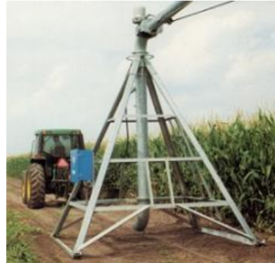
ب- محور مسحوب علي زلاجات. ج - محور مجرور علي عجلتان. شكل ١٤ : محور مسحوب أو مجرور.
