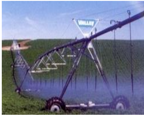
شكل ٢٧: استخدام الأبراج القصيرة عند زيادة اختلاف مناسيب سطح التربة.
