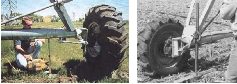
شكل ١٠٢ : إستخدام الرافعة الهيدرولية أو الكهربائية لرفع أي وحدة قابلة للسحب عند دعامة القاعدة.
