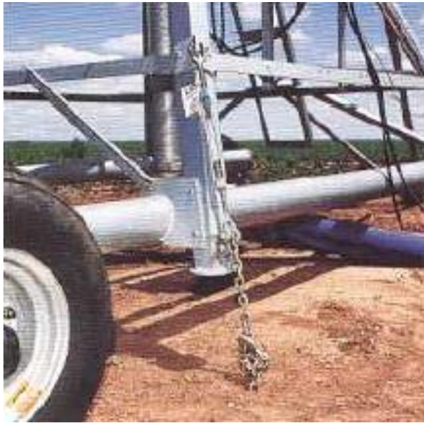
شكل ١١٤ : سلاسل تثبيت وربط المحور بتثبيتات أرضية أو قاعدة خرسانية.
