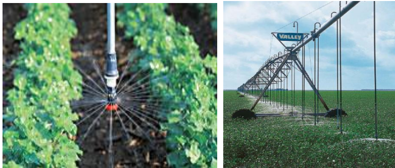
شكل ٧: استخدام الأنابيب الهابطة لتحسين كفاءة الري.
