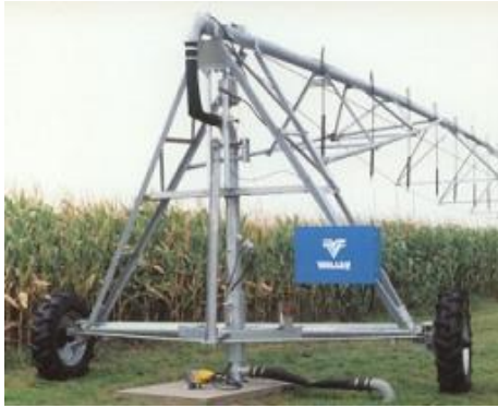
ب- محور مسحوب علي زلاجات. ج - محور مجرور علي عجلتان. شكل ١٤ : محور مسحوب أو مجرور.
