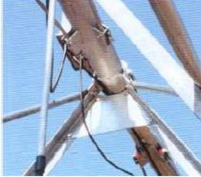
شكل ٣١: دعامات مثلثية متصلة مع السيقان ملفوفة بالكامل مع وحدة الدفع بقطعة واحدة تؤمنان مزيداً من المتانة، تمنع وصلات التقوية الثقيلة التواء الأنابيب.
