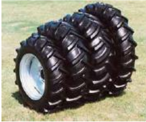
شكل ٣٨: العجلات بأحجام مختلفة تبعا لنوع التربة.
