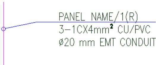
قم بوضع مشاورة (Multileader) لكل دائرة (لينية) تعبر عن اسم اللوحة المتصلة بها و رقم الدائرة (Circuit) و عدد وحجم الأسلاك (Wires) وكذلك نوع العزل ونوع الماسورة وقطرها كما بالشكل
