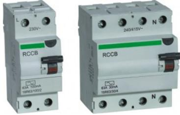
يفضل استخدام - Residual Current Devices (RCD) أو RCCB أو Earth Leakage Circuit Breaker (ELCB) في الدوائر الكهربائية التي بالحمامات و Wet Areas وتكون الحساسية لها 30mA
