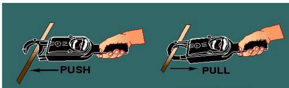
الشكل ١٠: ٣ محول التيار ذو القلب الحديدي المشطور مزود بآميتير
