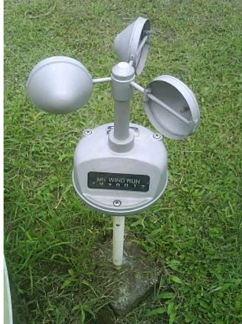
الشكل 9: جهاز الانيموميتر لقياس سرعة الرياح [19].
