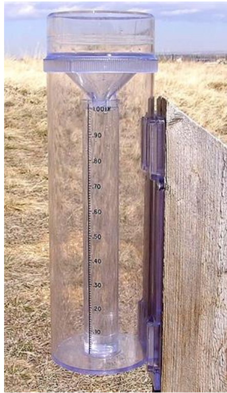
الشكل 12: جهاز قياس معدل الأمطار [22].
