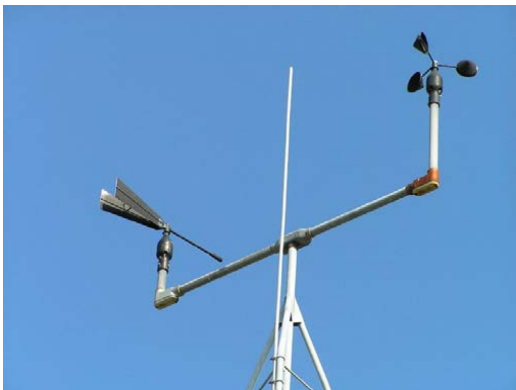
الشكل 11: جهاز الانيموميتر ودَوَّارة الرياح الحديث [21].
