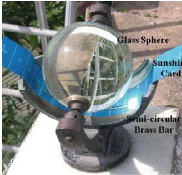
الشكل 13: جهاز كامبل-استوكس (Campbell -Stokes) لتحديد زمن السطوع [25].
