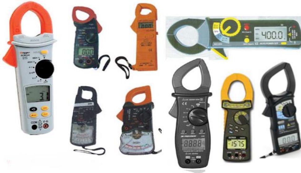
شكل رقم ١٠٦: أشكال مختلفة من أجهزة الكلامب ميتر
