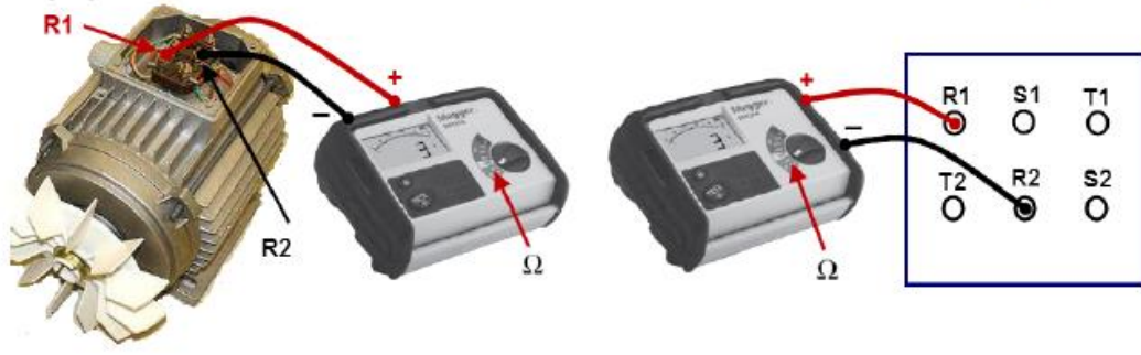
شكل رقم ١٠٥: قياس استمرارية التوصيل في محرك كهربائي باستخدام جهاز الميكر
