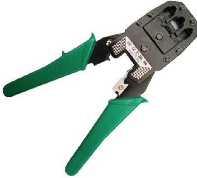
شكل رقم ٢٤: زردية التليفون
