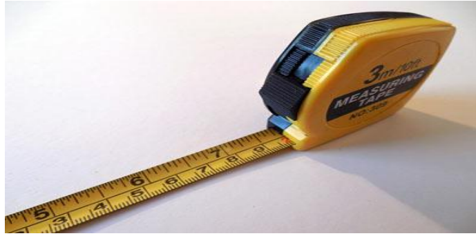
شكل رقم ١١: شريط قياسي معدني ملفوف
