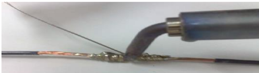
شكل رقم ١٤٧: لحام الوصلة العدلة.
