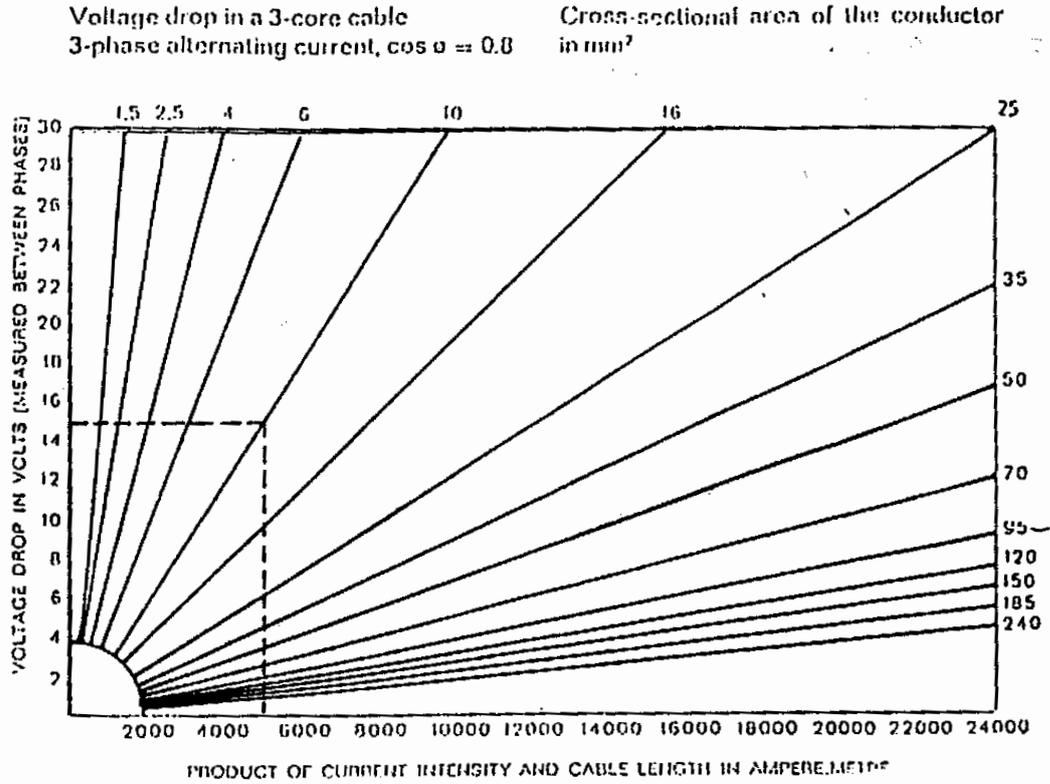
شكل رقم (٤-١٣) نوموجرام حساب التنزيل في الجهد للكابلات ثلاثية الأقطاب لإمرار التيار المتردد ثلاثي الوجه عند معامل قدرة واحد صحيح.
