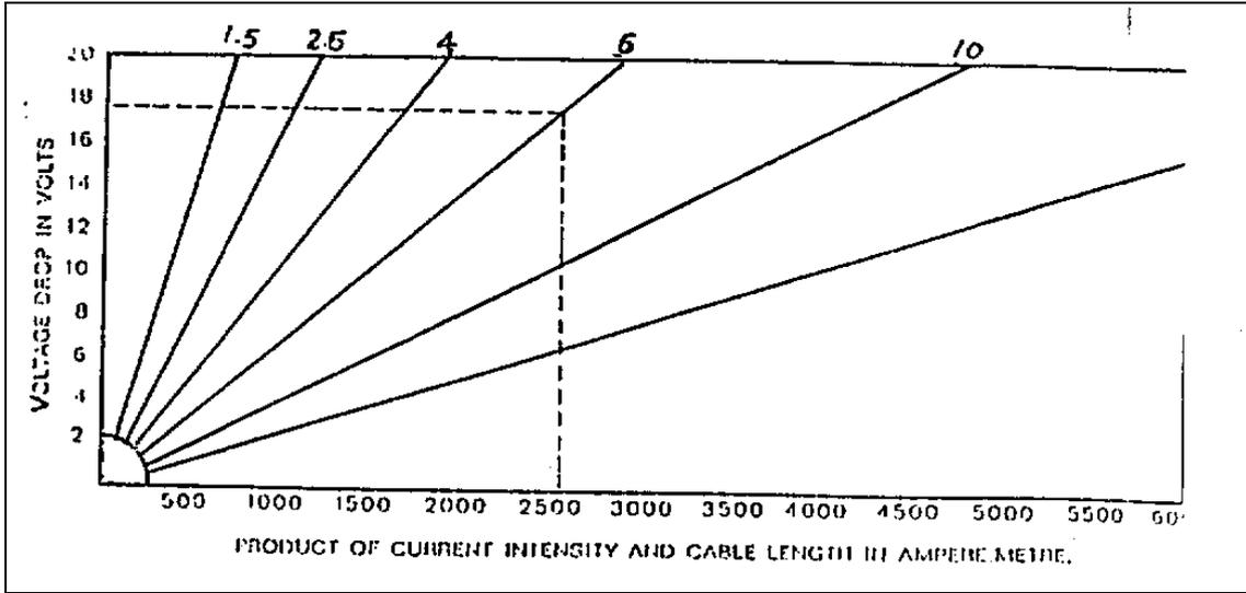
شكل رقم (١٢-٤) نوموجرام حساب التنزيل في الجهد للكابلات ثنائية القطب لإمرار التيار ذو الوجه الواحد عند معامل قدرة واحد صحيح.
