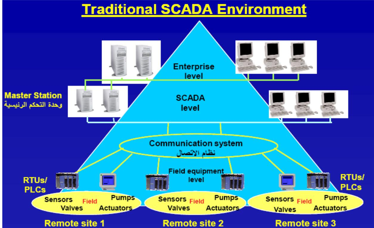
شكل (٤-١٦) بيئة تقليدية لنظام التحكم والمراقبة (SCADA).
