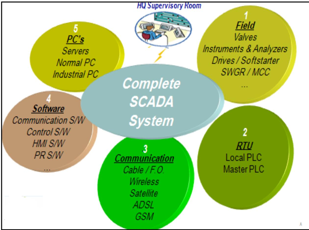
شكل (٤-١٧) العناصر الأساسية المكونة لنظام التحكم والمراقبة (SCADA).
