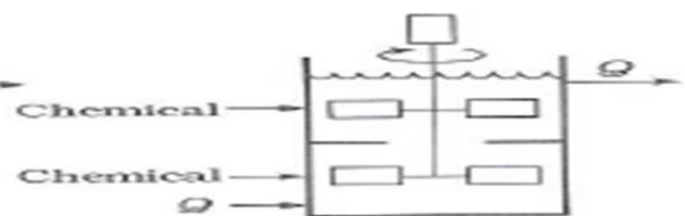
(d) Double Compartment Turbine Chamber
