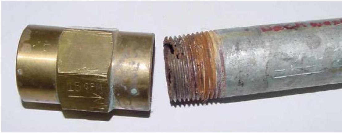
( صورة توضح تآكل الحديد عند توصيله بالنحاس )
