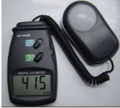
صورة 4-8 : أحد أشكال الـ Lux Meter
