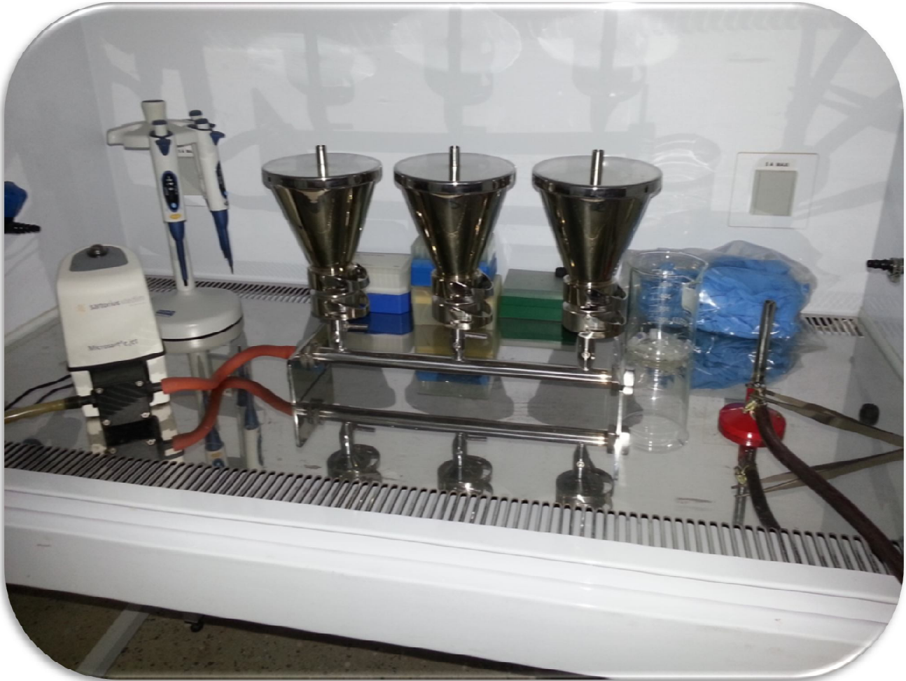
صورة توضح جهاز الترشيح مع ملحقاته المستخدم في الدراسة لعزل الميكروبات.
