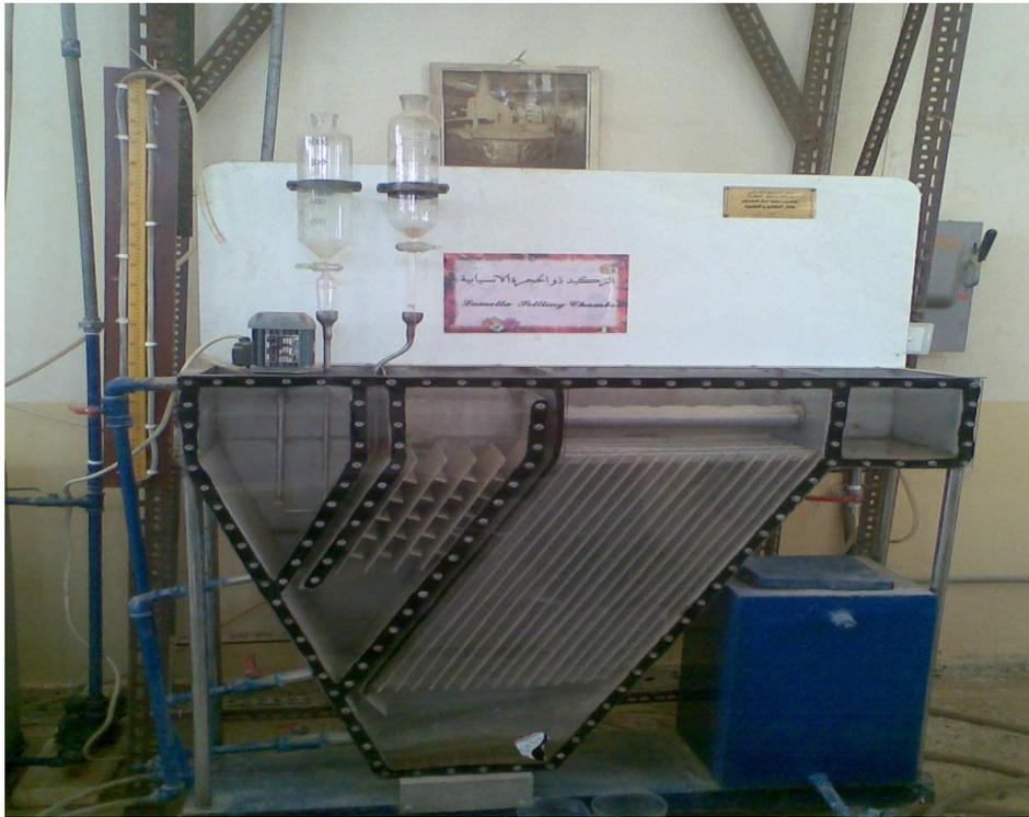
شكل رقم 2. جهاز الترسيب ذو الصفائح
