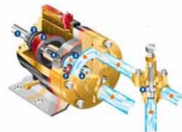
Figure 3.4 – Pompe à membrane [HYDRACELL].
