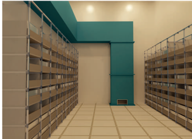
شكل (٩-٥-٢): ارتفاع مدخل الهواء في غرفة البطاريات
