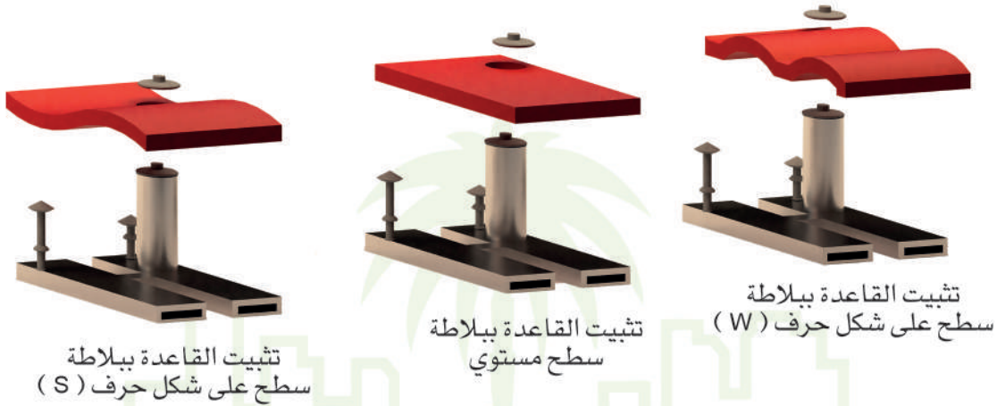
شكل ١٦-١-٢ (ب): التثبيت ببلاطات من البلاستيك أو الألمنيوم Mounting Tiles
