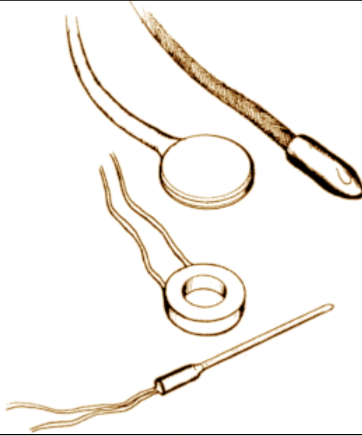
شكل (٣ - ٣) أنواع الثيرمسترات الشائعة للاستعمال Typical Thermistors
