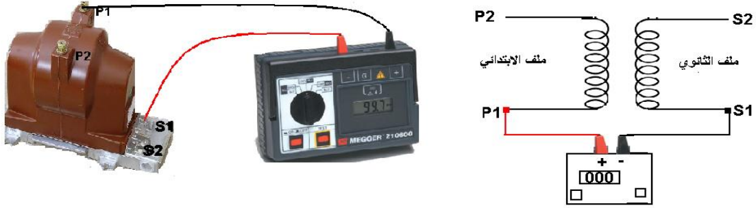
الشكل الثاني يوضح قياس بين ملفات الثانوية والارضي
