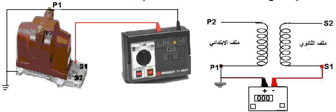
الشكل الثاني يوضح قياس بين ملفات الثانوية والارضي
