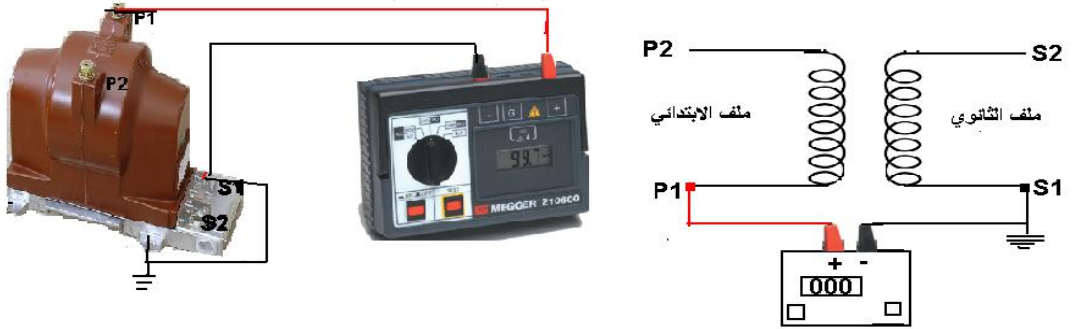
الشكل الثالث يوضح قياس بين ملفات الابتدائية والارضي
